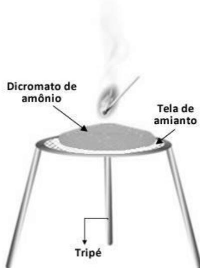
Nesse processo o dicromato de amônio sofre decomposição, com formação de três produtos, uma substância simples (gás nitrogênio) e duas substâncias compostas (óxido de cromo III e vapor de água) além de liberar energia.
