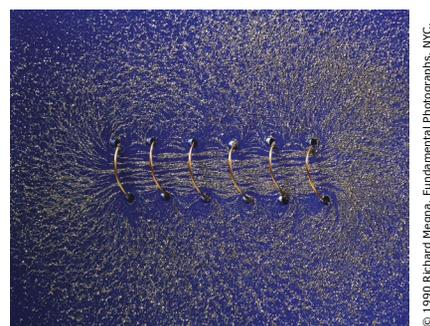
Veja, nas duas figuras anteriores, que as linhas de indução, dentro do solenoide, são praticamente paralelas. Isso indica que o módulo do campo magnético, nessa região, é praticamente uniforme e calculado conforme mostrado anteriormente.
