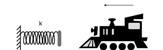
Admitindo-se que a locomotiva a ser parada tem velocidade de 7,20 km/h, massa de  $7,00 \cdot 10^4$  kg, e que a mola sofre uma deformação de 1 m, qual deve ser a constante elástica da mola?
