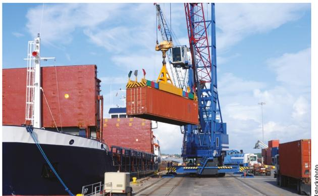
Dois motores distintos podem erguer o contêiner da figura anterior, a uma mesma altura  $h$ , em tempos diferentes. Ambos realizam o mesmo trabalho ( $W = Ph$ ), porém uma máquina o realiza em menos tempo. Dizemos, então, que as máquinas apresentam potências diferentes. A potência é uma grandeza física que mede a rapidez com a qual uma força realiza trabalho, isto é, o ritmo no qual um sistema transfere energia para outro. Matematicamente, podemos escrever que:
