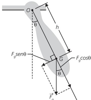
A figura representa um pêndulo físico. O ponto O está fixo e um corpo extenso oscila em torno de O. A equação, para esse caso, deve ser da seguinte maneira:
