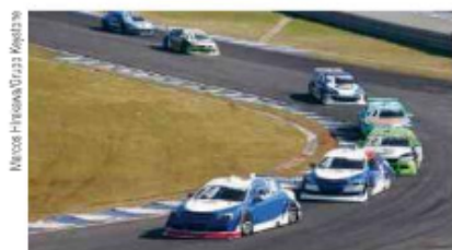
A imagem deixa claro o procedimento dos pilotos ao fazer a curva: eles buscam a trajetória de raio máximo, o que possibilita mais estabilidade e maior velocidade.
