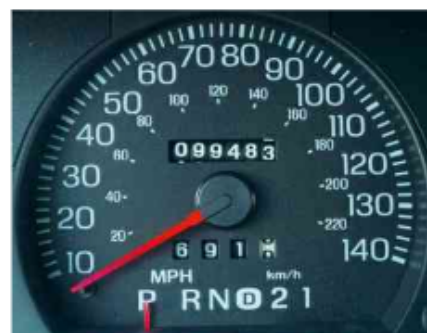
Velocímetro de um automóvel, com escala em milhas por hora e conversões aproximadas em quilômetros por hora. Confira a equivalência entre 50 MPH e 80 km/h.
