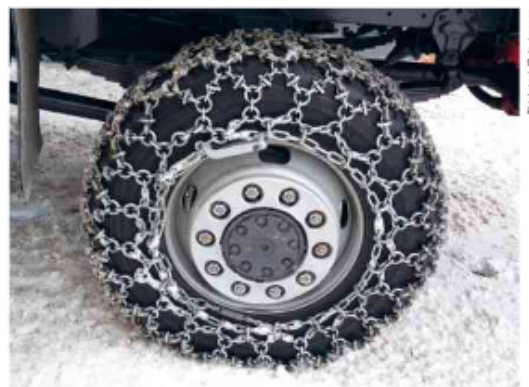
Para a locomoção sobre barro ou neve, pode-se revestir os pneus com correntes. Dessa forma, é compensada a insuficiência de atrito.
