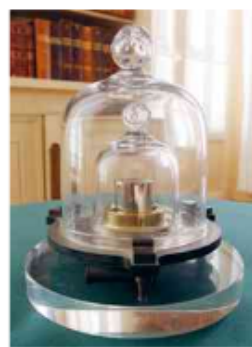
Fotografia do quilograma-padrão, exposto no Bureau Internacional de Pesos e Medidas, em Sèvres, França.
