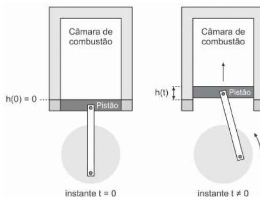
A função  $h(t) = 4 + 4\text{sen}\left(\frac{\beta t}{2} - \frac{\pi}{2}\right)$  definida para  $t \geq 0$  descreve como varia a altura  $h$ , medida em centímetro, da parte superior do pistão dentro da câmara de combustão, em função do tempo  $t$ , medido em segundo. Nas figuras estão indicadas as alturas do pistão em dois instantes distintos.
