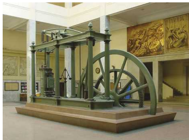
Fig. 2 O motor a vapor de James Watt.
