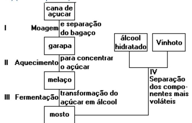
A obtenção do álcool etílico hidratado, a partir da cana-de-açúcar, pode ser representada pelo esquema a seguir. Em I e IV, que envolvem processos de fracionamento, são realizadas, respectivamente:
