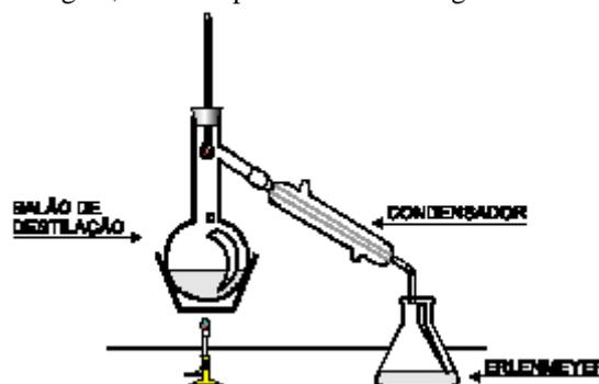
Suponha que a mistura é constituída de água e cloreto de sódio dissolvido nela. Ao final da destilação simples dessa mistura, obtém-se, no erlenmeyer,
