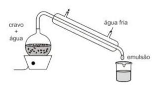
O processo de obtenção do eugenol no laboratório químico é relativamente simples, conforme indicado no aparato experimental representado na figura.
