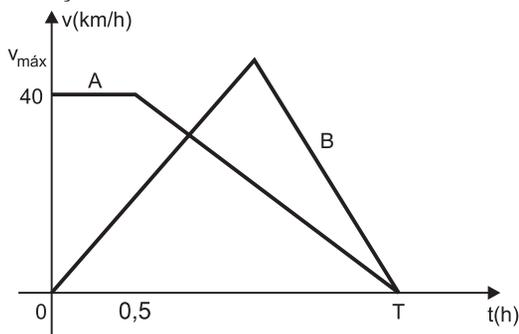
$$(1) \Delta s_A = \overset{N}{\text{Área}}_{\text{trapézio}} = \frac{(T + 0,5) \cdot 40}{2}$$
