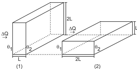
A mesma quantidade de calor  $\Delta Q$  gasta tempos  $\Delta t_1$  e  $\Delta t_2$  para atravessar a barra nas situações 1 e 2, respectivamente.
