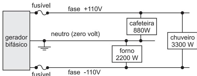
Admitindo que os aparelhos funcionam simultaneamente durante duas horas, calcule a quantidade de energia elétrica consumida em quilowatt-hora (kWh) e, também, a capacidade mínima dos fusíveis, em ampère.
