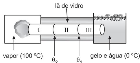
Supondo-se que, em volta das barras, exista um isolamento de lã de vidro e desprezando quaisquer perdas de calor, determine as temperaturas  $\theta_1$  e  $\theta_2$  nas junções das barras, conforme mostra a figura.
