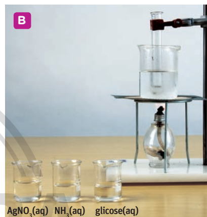
Formação de prata metálica (espelho de prata) (A) pela reação de glicose e soluções aquosas de amônia e nitrato de prata (B).
