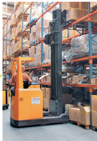
O motor desta empilhadeira é acionado pela energia elétrica.
