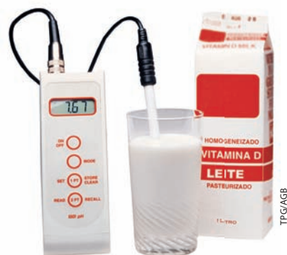
Peagômetro exibindo valor de pH do leite fora do padrão, que é 6,6.
