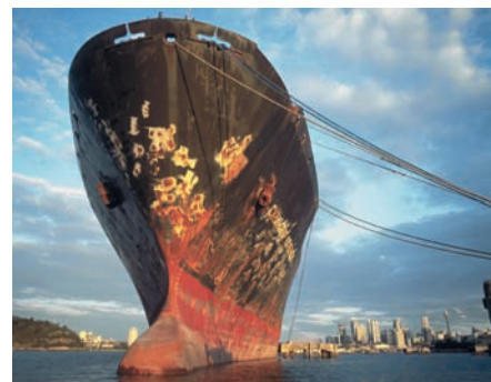
Quando não recebem pinturas com frequência, os cascos dos navios são rapidamente corroídos pela ferrugem.
