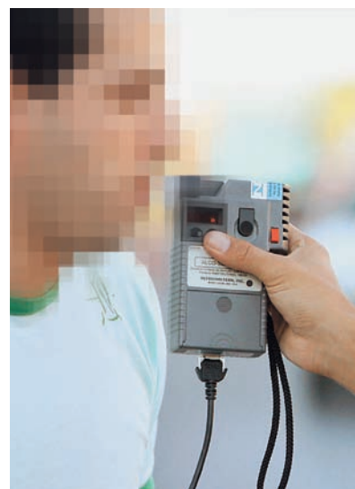
O bafômetro é um aparelho que mede a concentração de álcool no sangue por meio do ar expirado.
