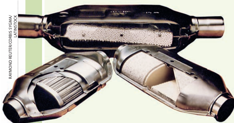
O conversor catalítico é colocado no tubo de escapamento dos automóveis.
