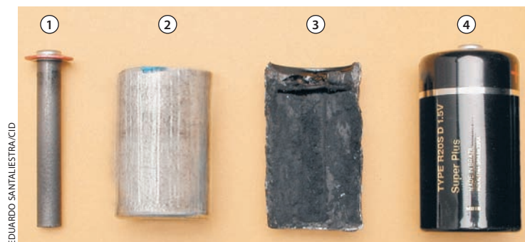
Principais elementos de uma pilha: ①, cilindro de carvão; ②, invólucro de zinco; ③, pilha vista em corte; ④, a pilha inteira.
