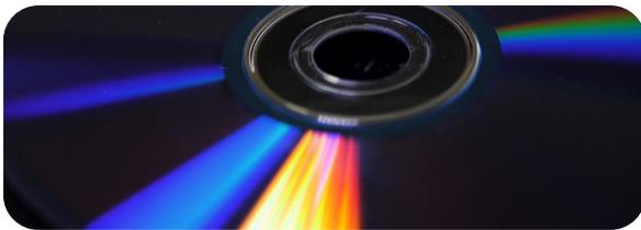
Redes de difração provocam essa separação através de uma interferência luminosa. É isso o que observamos quando vemos aquele belo padrão de cores na superfície de um CD.
