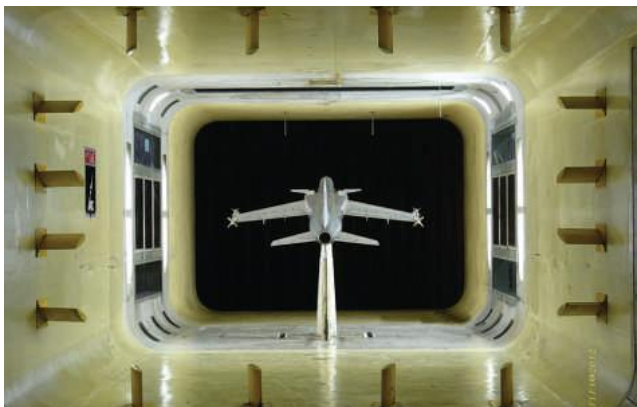
Fig. 1 Modelo de aeronave em túnel de vento no IAE.
