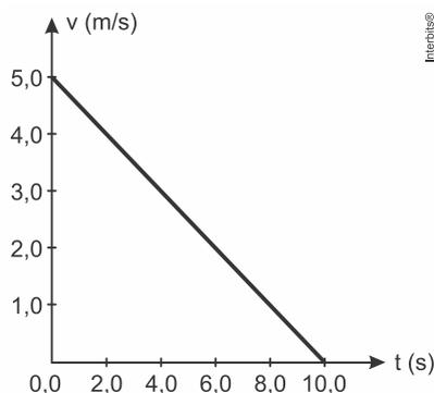
Um corpo de massa 2,0 kg é lançado sobre um plano horizontal rugoso com uma velocidade inicial de 5,0 m/s e sua velocidade varia com o tempo, segundo o gráfico acima.
