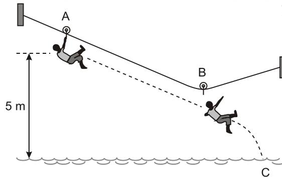
Considere que uma pessoa de 50 kg parta do repouso no ponto A e desça até o ponto B segurando-se na roldana, e que nesse trajeto tenha havido perda de 36% da energia mecânica do sistema, devido ao atrito entre a roldana e a corda. No ponto B ela se solta, atingindo o ponto C na superfície da água. Em seu movimento, o centro de massa da pessoa sofre o desnível vertical de 5 m mostrado na figura.
