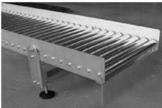
Essas esteiras são formadas por vários cilindros circulares retos e de mesmo tamanho, construídos a partir chapas metálicas e presos lado a lado a chapas laterais, igualmente afastados um do outro, e giram em um mesmo sentido e com a mesma velocidade, acionados por uma corrente ligada a um rotor. Suponha que uma esteira desse tipo tenha 1 200 cm de comprimento e 40 cm de largura na parte interna e que os cilindros circulares sejam afastados 2 cm um do outro e possuam 4 cm de raio cada um.
