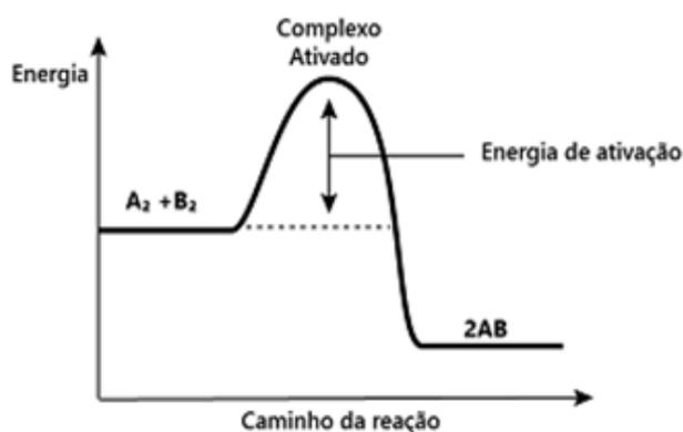
De acordo com o gráfico, as moléculas dos reagentes  $A_2$  e  $B_2$  colidem sucessivamente até que suas ligações são enfraquecidas e formam o complexo ativado, um estado de alta energia em que as ligações covalentes entre os átomos das moléculas dos reagentes são rompidas e são formadas ligações covalentes das moléculas do produto  $AB$ .
