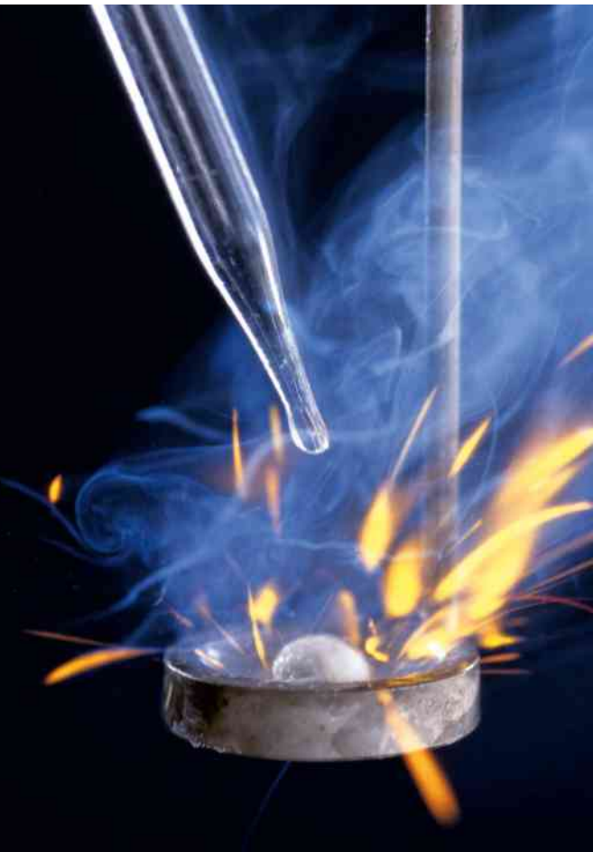
Reação entre sódio metálico e água. Essa reação libera uma grande quantidade de energia e pode causar sérios acidentes.
