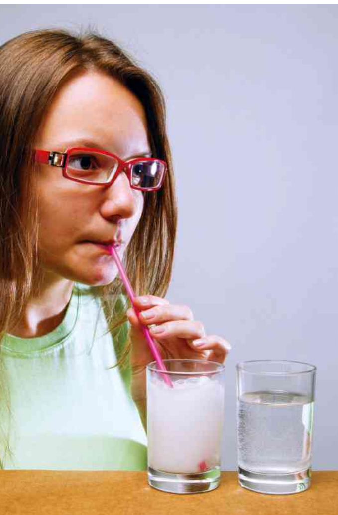
O gás carbônico que liberamos na respiração turva a água de cal por causa da formação de carbonato de cálcio.
