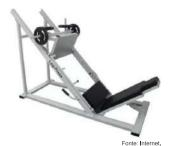
Considere a situação na qual uma pessoa, ao utilizar o aparelho, ajusta em 30° o ângulo do plano inclinado formado pelos trilhos com a horizontal. Ao empurrar com as pernas a parte móvel, de massa igual a 50kg, passa a deslizar para cima com velocidade constante. Se o coeficiente de atrito cinético entre a parte móvel e o plano inclinado é igual 0,10, podemos afirmar que a intensidade da força exercida pelas pernas, nessa situação, é igual a:
