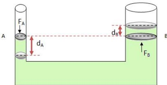
(Uma máquina hidráulica é um dispositivo capaz de multiplicar o efeito de uma força por meio da transmissão da pressão exercida por essa força em um líquido.)
