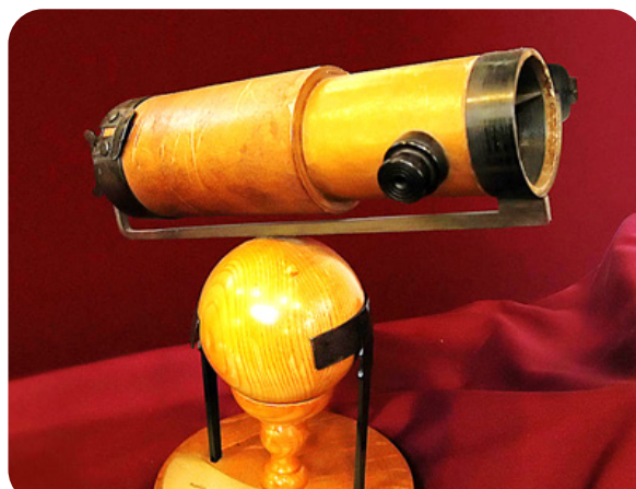
Réplica do telescópio de Isaac Newton. O telescópio newtoniano é também chamado de telescópio refletor, por possuir espelhos planos refletores em seu funcionamento.
