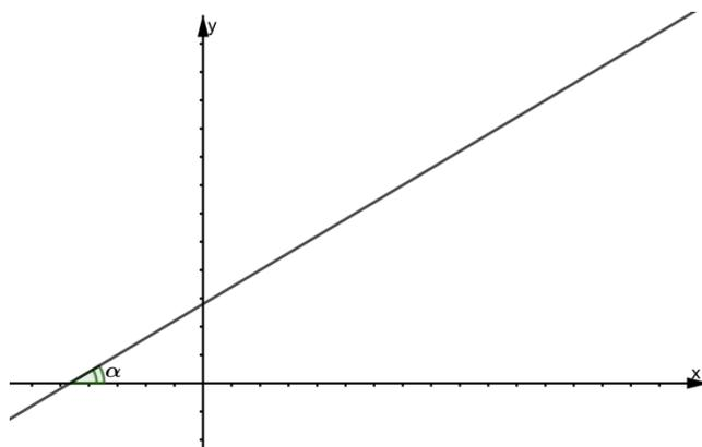
Chama-se coeficiente angular de uma reta e indica-se por  $m$  o número que é a tangente do seu ângulo de inclinação da reta.
