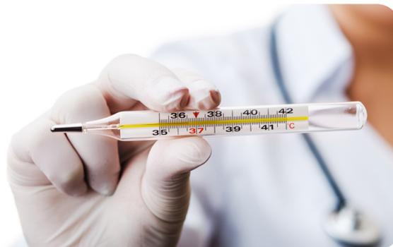
Esse tipo de termômetro mede a temperatura por meio da dilatação ou contração do mercúrio (que é líquido a temperatura ambiente).
