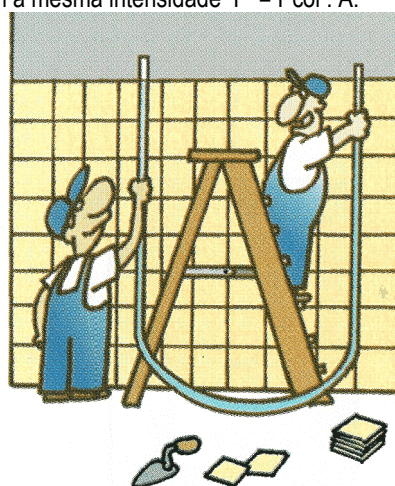
Figura 11 C - os pedreiros utilizam o princípio dos Vasos Comunicantes para nivelar os azulejos da parede, durante uma obra.
