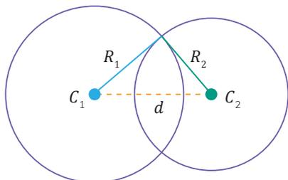
$$|R_1 - R_2| < d < R_1 + R_2$$
