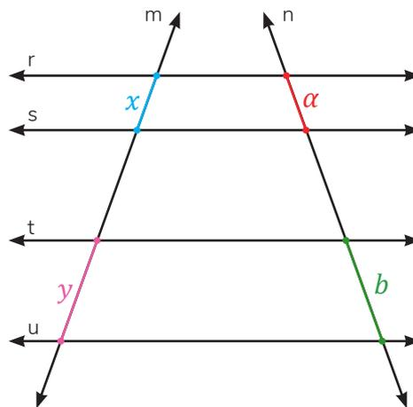
Pelo teorema, a razão entre dois segmentos de retas da primeira transversal é proporcional à razão entre os dois segmentos de reta correspondentes na segunda transversal.
