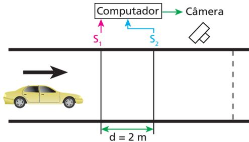
Os sensores  $S_1$  e  $S_2$  e a câmera estão ligados a um computador. Os sensores enviam um sinal ao computador sempre que são pressionados pelas rodas de um veículo. Se a velocidade do veículo está acima da permitida, o computador envia um sinal para que a câmera fotografe sua placa traseira no momento em que esta estiver sobre a linha tracejada. Para certo veículo, os sinais dos sensores foram os seguintes:
