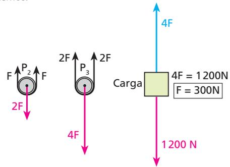
**11** (Ufop-MG) O sistema de roldanas da figura está sendo usado para elevar, em equilíbrio, um objeto de peso **P**.
