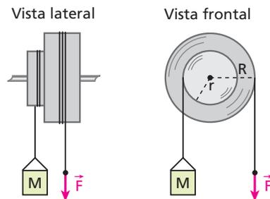
Cordas leves estão enroladas nessas roldanas. Em uma delas, está suspenso um bloco de massa **M** igual a 50 kg e o sistema é mantido em equilíbrio pela força vertical  $\vec{F}$  aplicada na outra corda. Considerando  $g = 10 \text{ m/s}^2$ , calcule a intensidade de  $\vec{F}$ .
