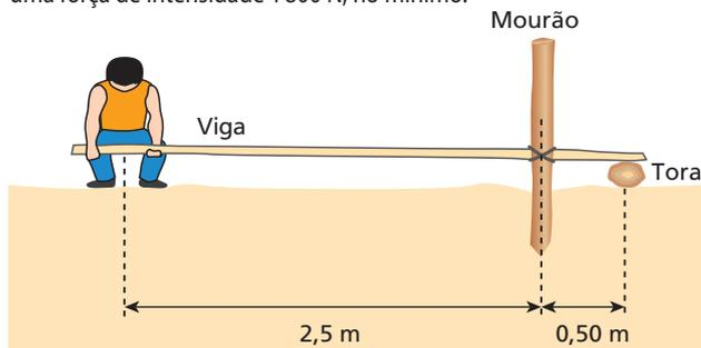
Usando uma viga amarrada no mourão e apoiada em uma tora, como sugere a figura, determine a mínima intensidade da força que o homem precisa exercer na viga para arrancar o mourão. Para simplificar, desconsidere o peso da viga e suponha que a força total exercida nela pelo homem esteja aplicada no ponto médio entre suas mãos.
