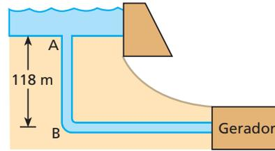
Calcule, em MW, a potência hídrica na entrada do gerador.
