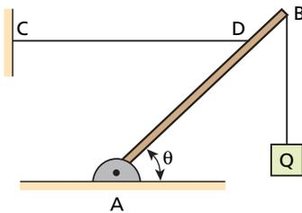
São dados  $AD = 300 \text{ cm}$ ,  $DB = 100 \text{ cm}$  e  $\theta = 45^\circ$ . A viga é articulada sem atrito em **A** e suporta em **B** um corpo de peso  $Q = 120 \text{ kgf}$ . Determine o esforço no cabo e as componentes horizontal e vertical da força que a viga recebe na articulação em **A**.
