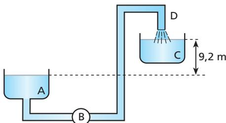
Considere  $g = 10 \text{ m} \cdot \text{s}^{-2}$  e a massa específica da água igual a  $1,0 \cdot 10^3 \text{ kg} \cdot \text{m}^{-3}$ . Despreze as dissipações de energia. Qual a potência da bomba em kW?
