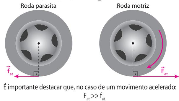
**26** (ESPCEX-SP – mod.) A figura abaixo representa um automóvel em movimento retilíneo e acelerado da esquerda para a direita. Os vetores desenhados junto às rodas representam os sentidos das forças de atrito exercidas pelo chão sobre as rodas.
