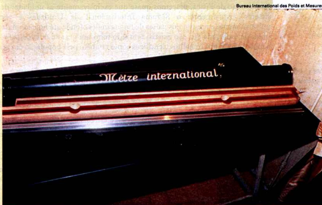
Fig.1-11: Cópia da barra de platina iridiada que constitui o metro padrão. Está guardada na Repartição Internacional de Pesos e Medidas, em Paris.
