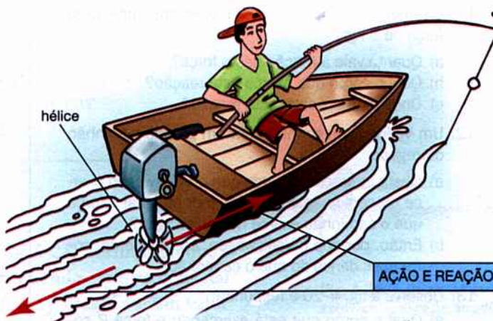
Ao girar, a hélice empurra a água para trás. A água reage e empurra a hélice para a frente, fazendo com que o barco se movimente.
