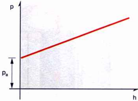
Fig.7-13: Este gráfico mostra como a pressão p no interior de um líquido varia com a profundidade h .
