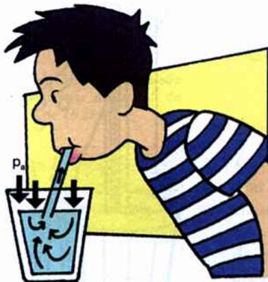
Fig.7-8: A pressão atmosférica atua na superfície do líquido, fazendo-o subir no canudinho.
