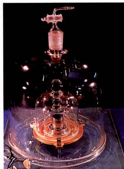
Fig.5-6-a: Cilindro de platina iridiada, guardado na Repartição Internacional de Pesos e Medidas, na França. Um quilograma (1 kg) é, por definição, a massa deste cilindro.
