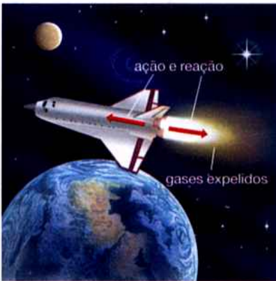
O movimento de um foguete (ou de um avião a jato) é causado pela força de reação exercida pelos gases que ele expele.
