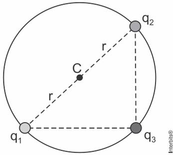
Considere  $V_C$  o potencial eletrostático e  $E_C$  o módulo do campo elétrico no ponto  $C$  devido às três cargas. Os valores de  $V_C$  e  $E_C$  são, respectivamente,
