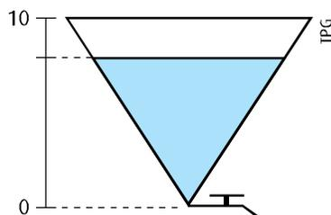
Uma torneira na parte inferior do recipiente permite controlar a quantidade de água que sai por unidade de tempo, ou seja, a vazão. Ao lado do recipiente há uma escala que indica a altura, em centímetros, do nível da água em relação ao seu ponto mais baixo.
