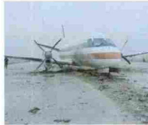
Avião retido na área de escape com EMAS Engineered Material Arresting System
