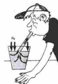
A pressão atmosférica atua na superfície do líquido, fazendo-o subir no canudinho.
