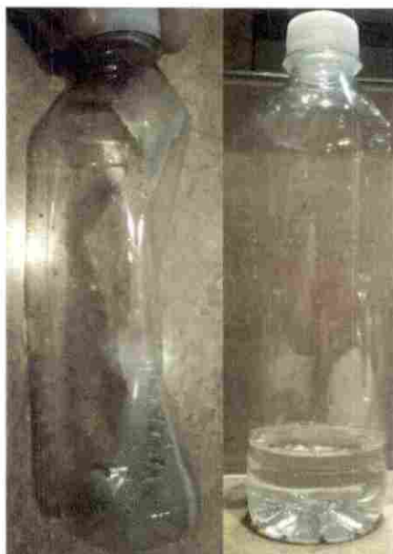
Garrafa com pressão interna igual à do avião, mas estando em um ambiente com pressão atmosférica a nível do mar (esquerda); Garrafa cuja diferença da pressão interna com a externa foi preenchida de água.
