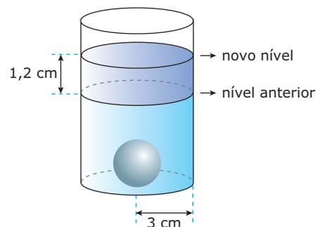
O volume da esfera imersa no cilindro é igual ao volume de água deslocada, que corresponde a um cilindro de raio 3 cm e altura 1,2 cm (em azul escuro). Assim:
