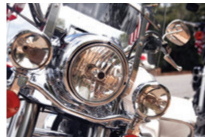
Farol de uma motocicleta com a forma de uma parábola.
