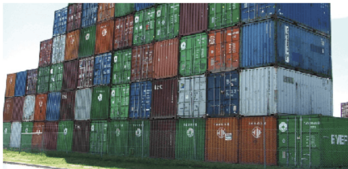
Fig. 24 Contêineres: caixas metálicas cheias de mercadorias. Elas podem ser transferidas de navios para trens, caminhões ou aviões rapidamente.
