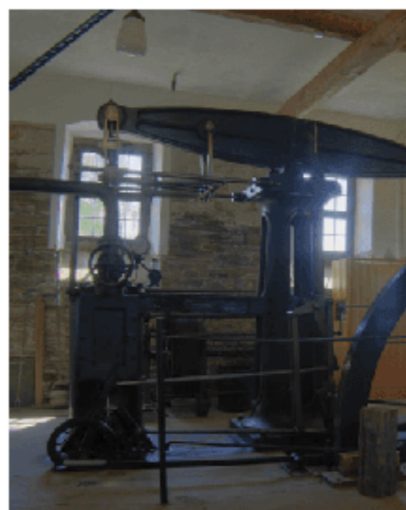
Fig. 4 A máquina a vapor usada para drenar água das minas (à esquerda) e o motor de combustão interna.
