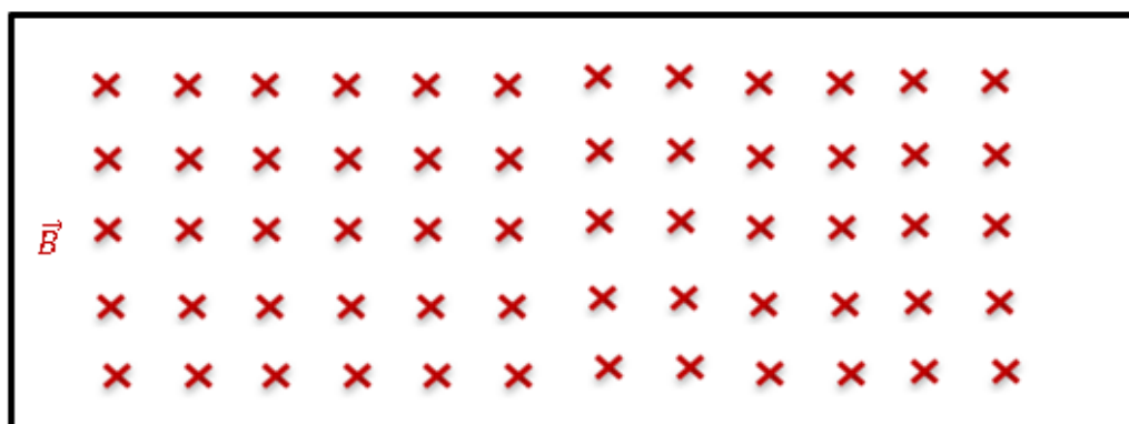
Figura 13: Representação do campo entrando no plano da folha.
