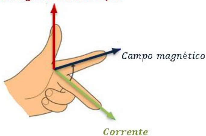
Figura 20: Regra da mão esquerda adaptada.
