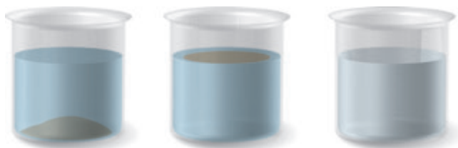
I. água e areia II. água e pó de gelatina III. água e sal Exemplos de dispersões distintas.
