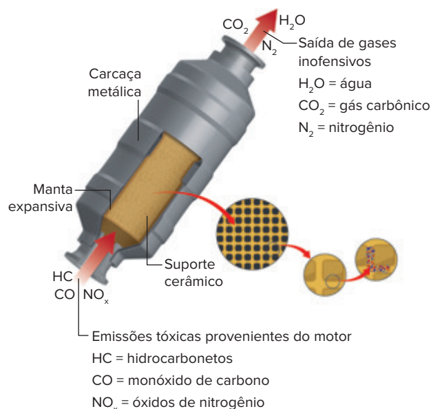
Esquema de um catalisador veicular mostrando sua ação na conversão de gases poluentes em inofensivos.
