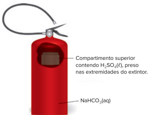
Configuração simplificada de um extintor de incêndio.
