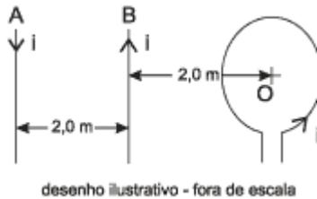
A espira e os fios são coplanares e se encontram no vácuo. Os fios 'A' e 'B' e a espira são percorridos por correntes elétricas de mesma intensidade  $i = 1$  A com os sentidos representados no desenho. A intensidade do vetor indução magnética resultante originado pelas três correntes no centro 'O' da espira é:
