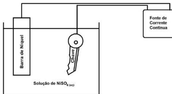
No processo de revestimento da chave com níquel ocorrerá, majoritariamente, uma reação de X, representada por uma semirreação Y. Nesse caso, o par X,Y pode ser representado por
