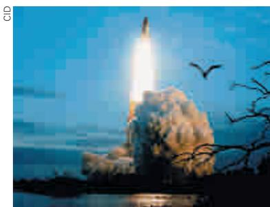
A reação exotérmica entre os gases hidrogênio e oxigênio, que forma água, é a responsável pela propulsão do ônibus espacial.
