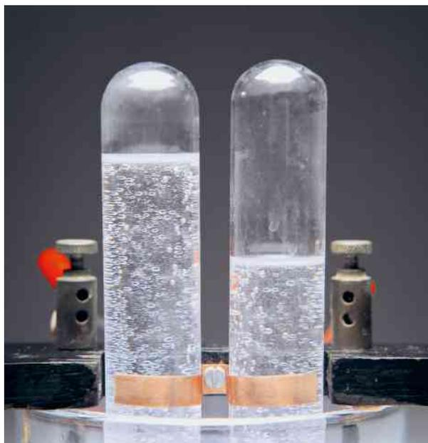
Montagem de laboratório para eletrólise da água
