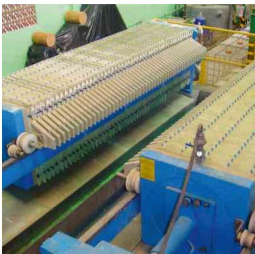
5. Filtragem e prensagem. Com filtros e prensa, é feita uma nova separação entre líquidos e sólidos.
