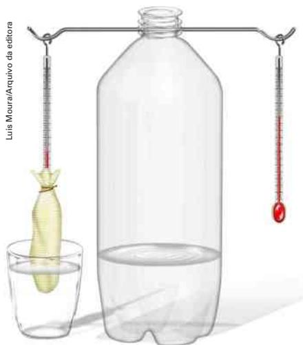
Ilustração esquemática do psicrômetro
