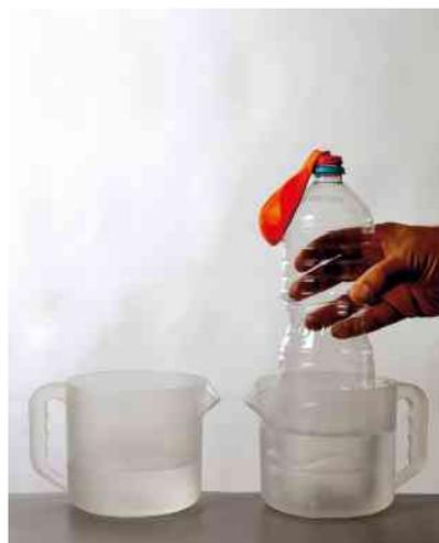
Garrafa PET imersa na água gelada. Se a temperatura diminui, o volume ocupado pelo ar no balão diminui.
