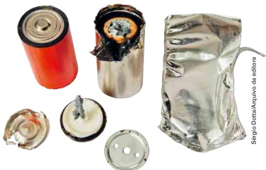
Pilha alcalina desmontada. Nunca tente desmontar uma pilha ao meio porque, ainda que a quantidade de metais pesados e substâncias tóxicas presentes seja pequena, elas existem, e o contato com elas pode desencadear problemas de saúde.
