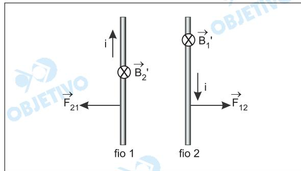
A seguir, usando-se a regra da mão esquerda em cada fio, obtemos as respectivas forças magnéticas  $\vec{F}_{12}$  e  $\vec{F}_{21}$ . As forças são repulsivas e os fios se afastam.
