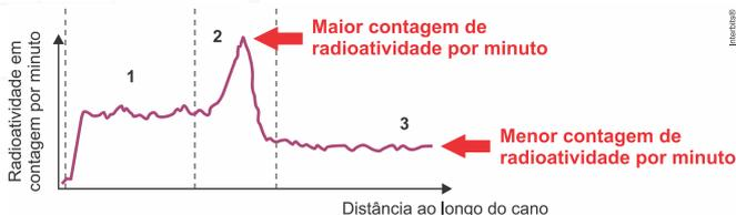
Como a contagem radioativa no trecho 3 é menor do que no trecho 2, conclui-se que a concentração do marcador radioativo ( ${}^{24}Na$ ) é maior no trecho 2, pois há uma fissura no cano, o que resulta em acúmulo de marcador nesse trecho do solo e uma diminuição posterior.
