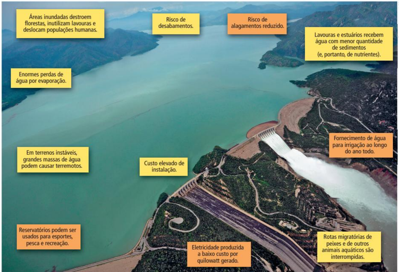
Figura 9. Efeitos do represamento da água de um rio. Em laranja, possíveis vantagens de uma barragem; em amarelo, possíveis desvantagens.
