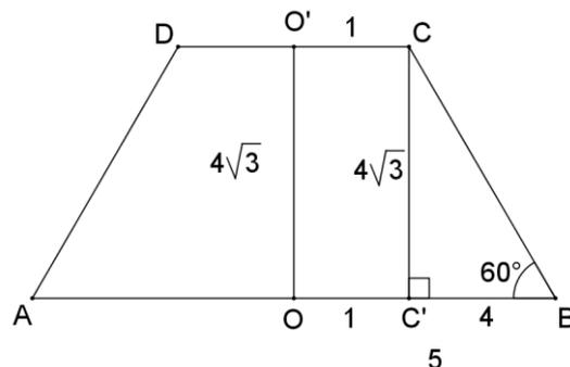
A figura acima representa a seção meridiana do tronco de cone. Projeta-se o ponto C sobre a base AB, obtendo-se o ponto C'.
