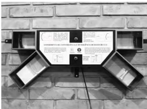
Nos compartimentos inferiores do dispositivo, há dois tipos de lentes, sendo possível observar a convergência e a divergência dos raios de luz que incidem nas lentes e delas emergem ao se acionar um botão.
