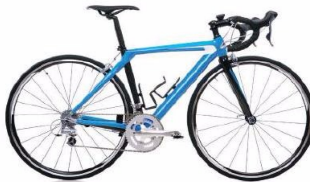
O termo raio é utilizado para se referir às hastes de metal que dão estabilidade à roda da bicicleta.
