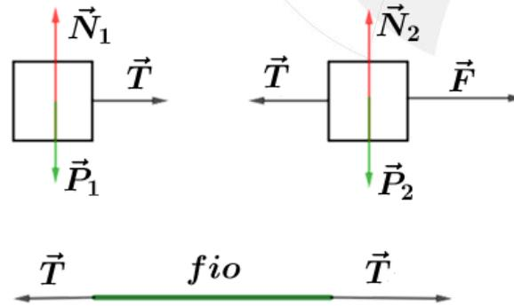
Dessa forma, podemos determinar o módulo da tração  $T$  no fio em função da força aplicada:
