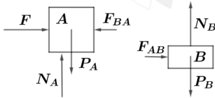
Dado que o conjunto bloco A + bloco B andam juntos, podemos determinar a aceleração do sistema, para força  $\vec{F}$  aplicada:
