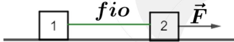
Vamos desconsiderar o atrito entre os blocos e a superfície. Dizemos que o bloco 1 tem massa  $m_1$ , bloco 2 tem massa  $m_2$  e o fio massa tem  $m_{fio}$ . Nesse conjunto blocos e fio, aplicamos uma força  $\vec{F}$  constante para a direita.
