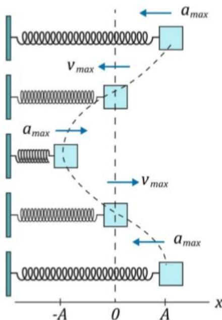
Figura 5: Análise das velocidades e acelerações do bloco.
