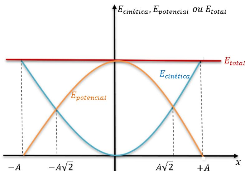
Figura 7: Variação da energia em função do deslocamento.
