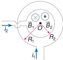
De acordo com a regra da mão direita nº 1, os vetores  $\vec{B}_1$  e  $\vec{B}_2$  originados por  $i_1$  e  $i_2$  em  $O$  têm mesma direção e sentidos opostos. Para que o vetor indução magnética resultante seja nulo, os módulos de  $\vec{B}_1$  e  $\vec{B}_2$  devem ser iguais:
