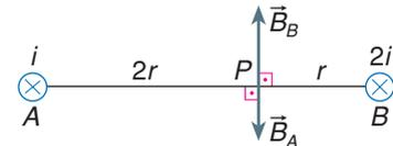
A agulha colocada em  $P$  se orienta na direção do vetor indução magnética resultante ( $\vec{B}_R$ ), com polo norte no sentido de  $\vec{B}_B$  (pois  $B_B > B_A$ ).
