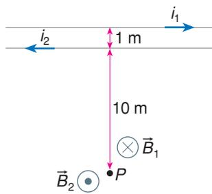
Pela regra da mão direita nº 1, determinamos os sentidos dos vetores campo magnético,  $\vec{B}_1$  e  $\vec{B}_2$ , que  $i_1$  e  $i_2$  originam em  $P$ .
