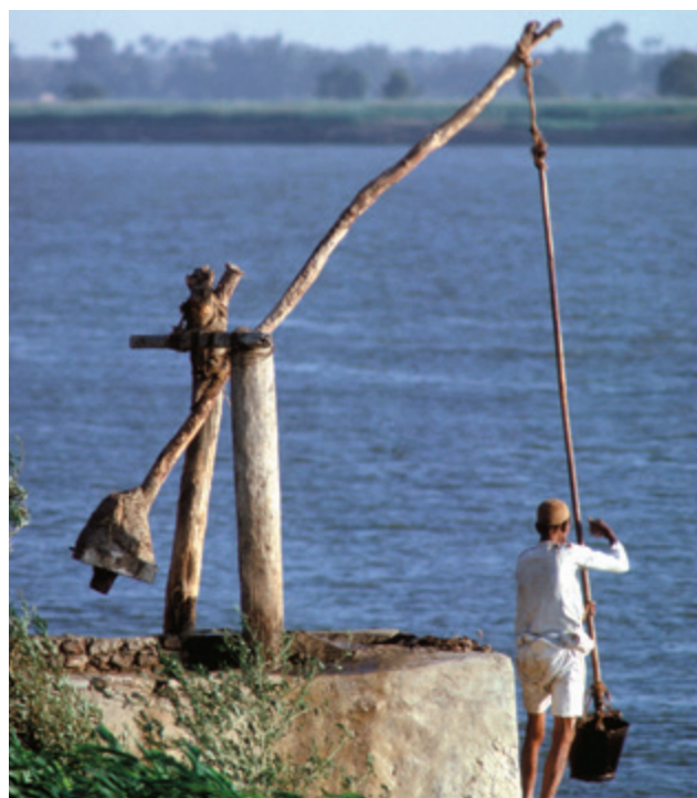
Shaduff, um antigo instrumento para obtenção de água. Egito, foto atual.
