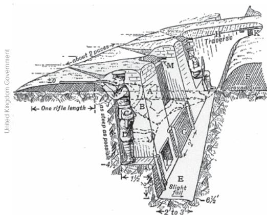
Fig. 17 Esquema de uma trincheira em um manual inglês.
