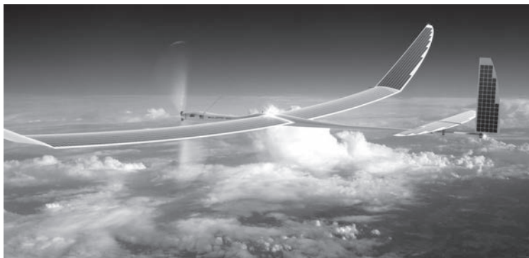
Titan Aerospace: uma alternativa aos (caros) satélites. Utiliza células fotovoltaicas, este modelo reutilizável poderia com suas células funcionar por mais de cinco anos substituindo satélites.
